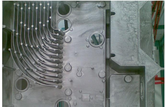
Aluminium-Wechselrichtergehäuse nach der Vorbehandlung **HAKUPUR® 50-459** und chromfreie Konversionsbeschichtung **DECORRDAL® AL 230A**.
